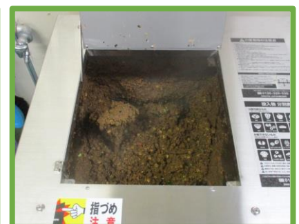
処理槽内③：投入後 約24時間経過
