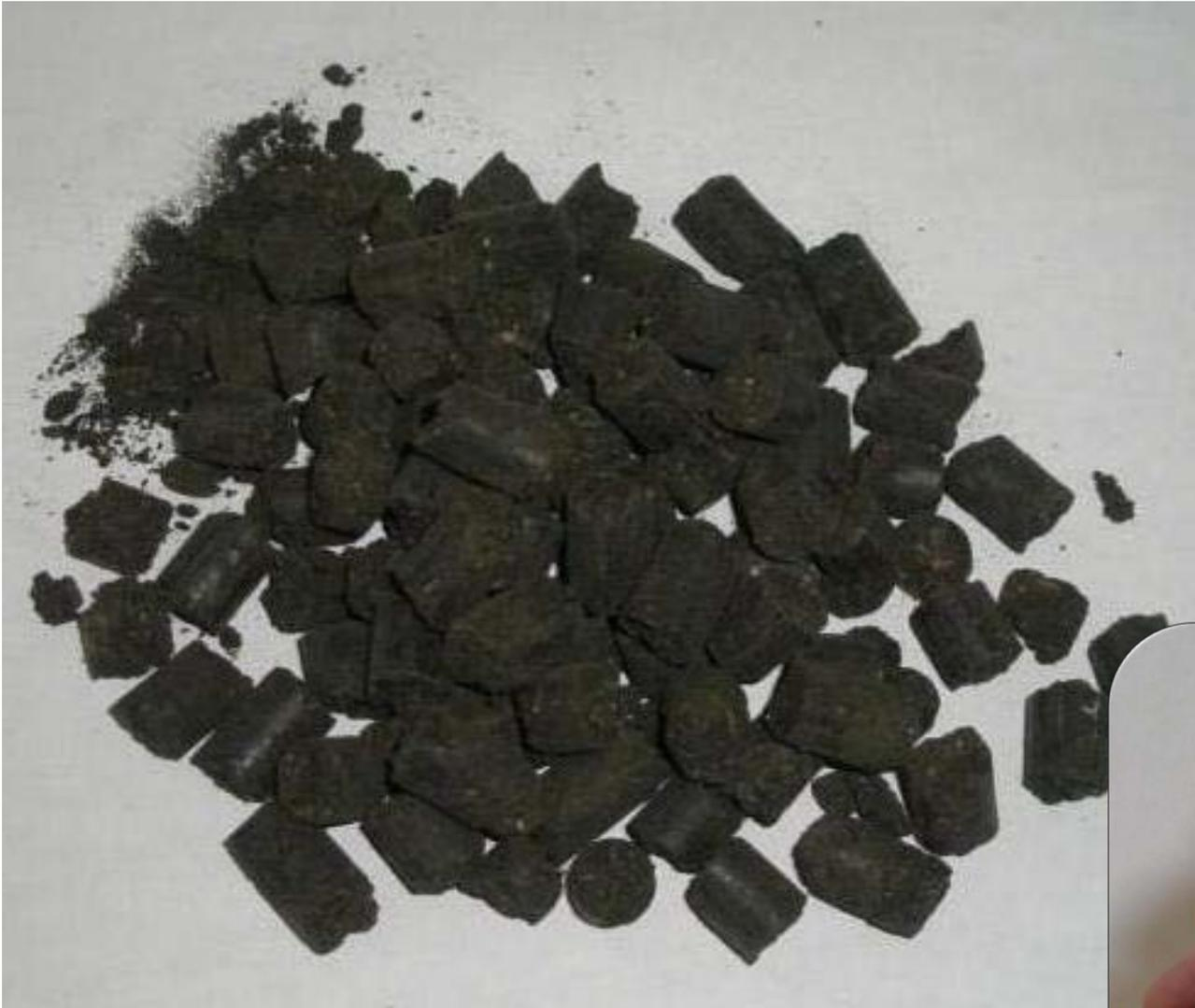
脱水・乾燥の工程を経た残りカスは圧縮してペレット状に成形します。
