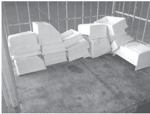
手分解による樹脂部品回収（冷蔵庫部品）
